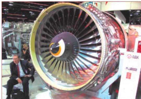
Пермское «наше всё» — ПС90-А2 на стенде Объединенной двигателестроительной корпорации
