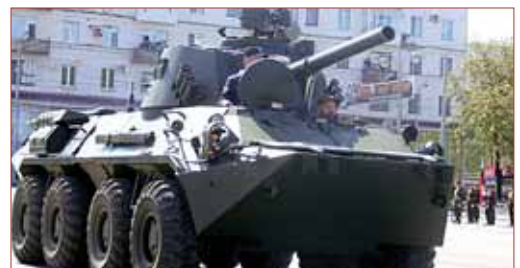
Самоходная установка с орудием «Нона»
