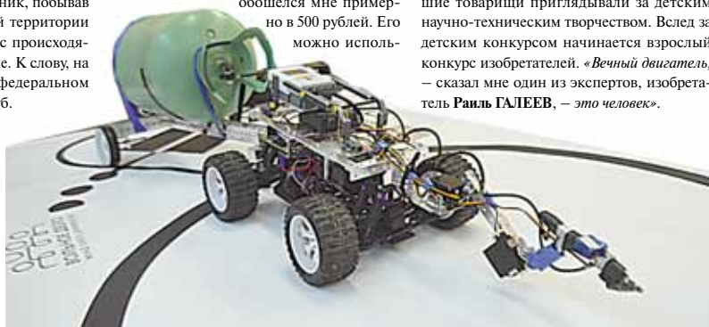
Робот-аэрограф может быть применим в опасных и недоступных местах
